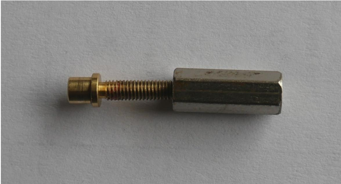
Nun versuchen wir das wieder gerade zu biegen. Wir spannen das Gewindestück in den Schraubstock und drehen die Welle hinein bis es klemmt.
