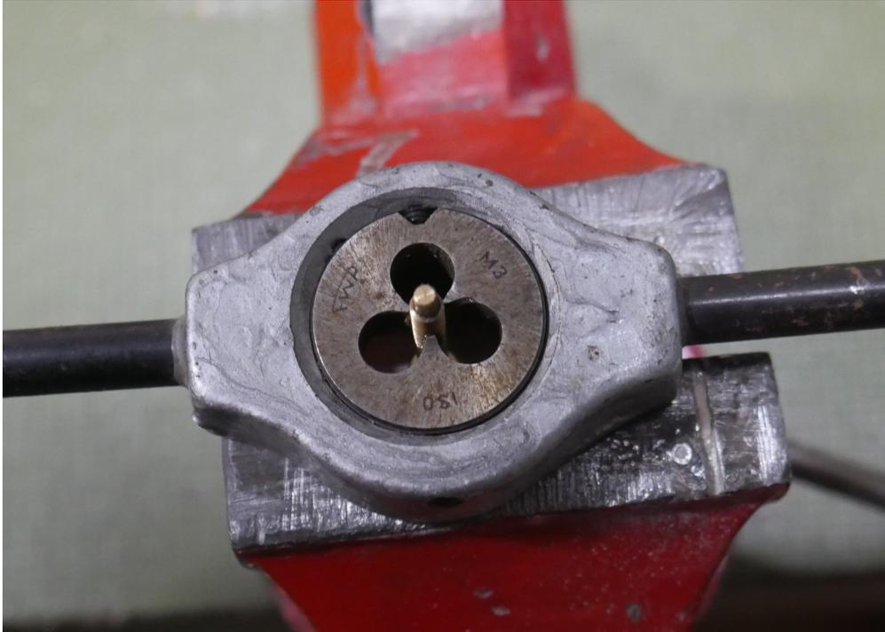
Zum Schluss das Gewinde mit einem M3 Schneideisen nachschneiden, Öl nicht vergessen. Nochmal mit dem Abstandsstück prüfen, ob alles leichtgängig ist.
